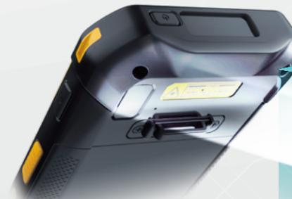
Der Akku mit Schnellverschluss spart Zeit beim Akkuwechsel
